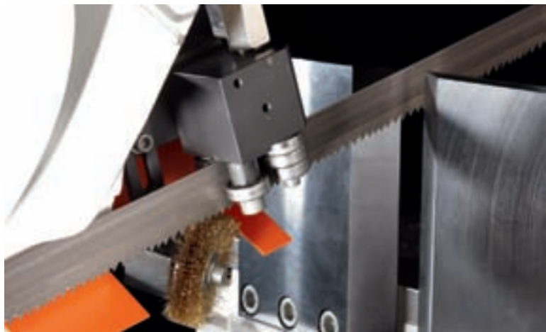
Guidage du ruban par galets.
