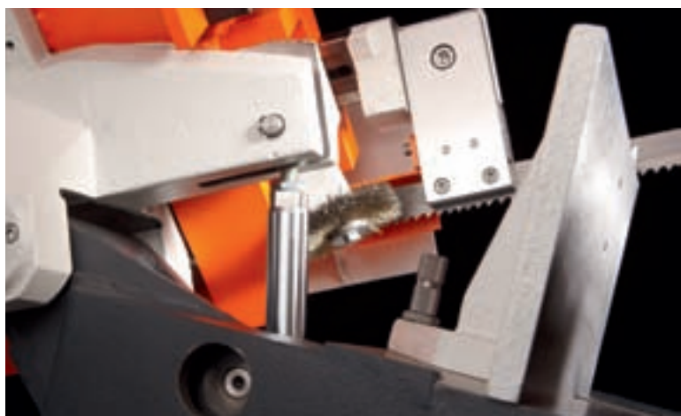
Nettoyage du ruban par brosse chasse-copeaux.
