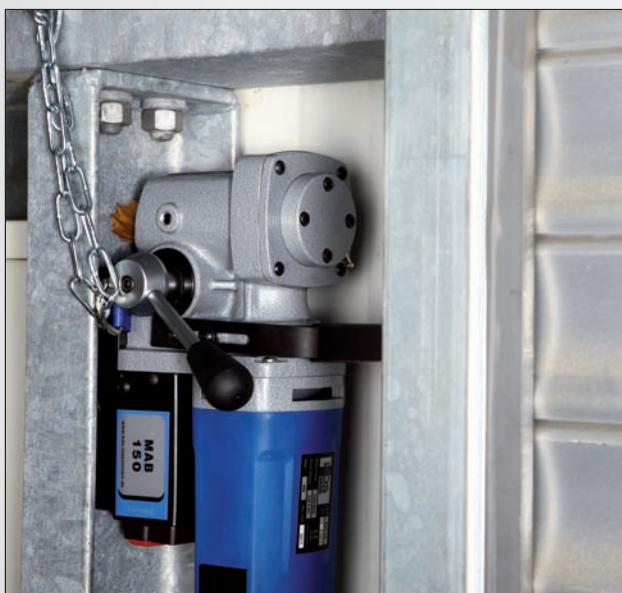
La MAB 150 peut être utilisée même dans les situations les plus étroites pour des perçages de jusqu'à \varnothing 35 mm.
