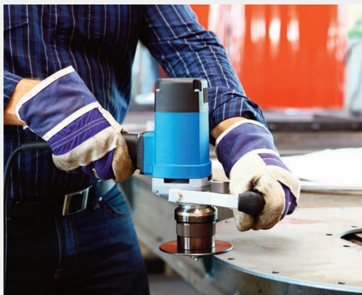
Série EKF – l'idéal pour l'ébavurage et l'adaptation des arêtes visibles et le traitement des rayons extérieurs.
