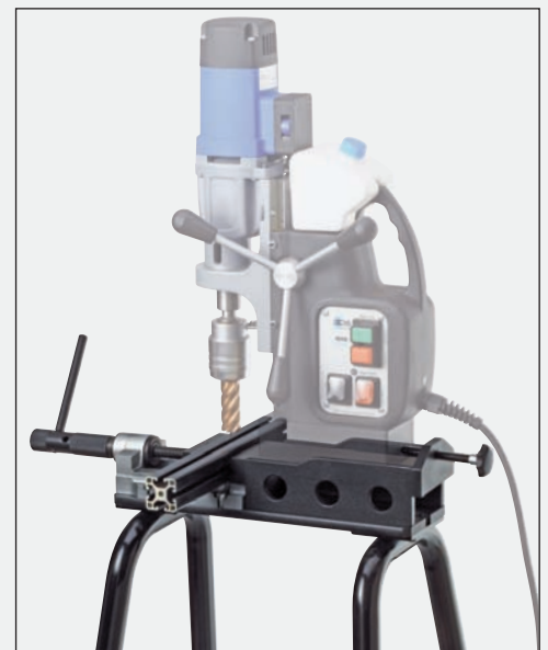
MobilCLAMP – travaillez de manière mobile avec des machines de carottage à embase magnétique.
