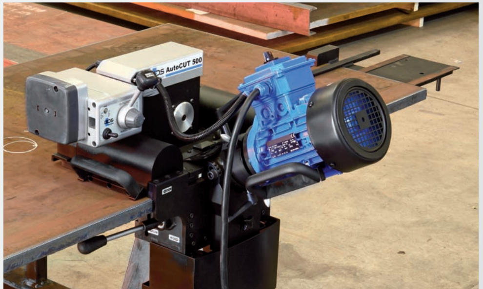
L'AutoCUT 500 avec avance et retour automatiques
