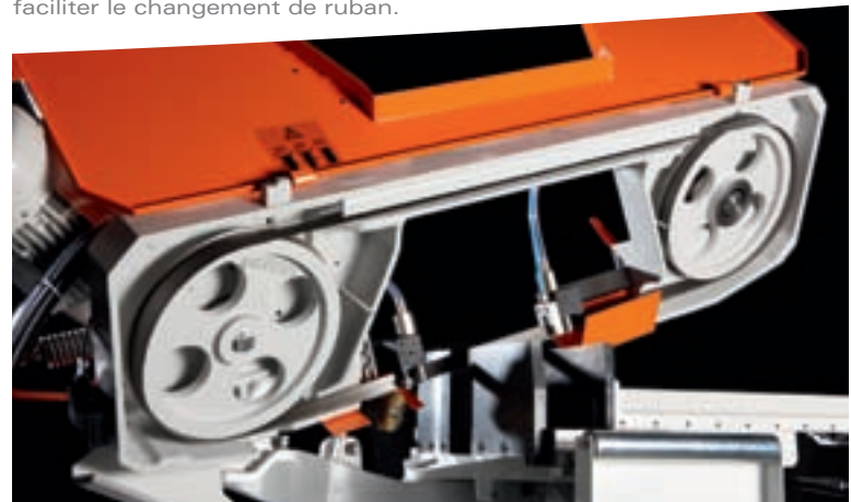
Capot ouvert, sécurité électrique pour faciliter le changement de ruban.
