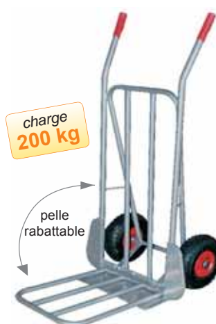
code FR STANDARD PELLE FIXE + RABATTABLE Largeur x hauteur : 560 x 1190 mm Pelle rabattable : 490 x 335 mm Roues gonflables
