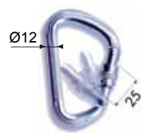
AZ014 alliage léger ouverture 25mm 113X73mm, 80 gr.
