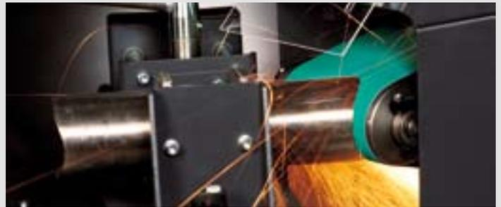
Grâce à son système de serrage rapide, le changement de la pièce à travailler avec l'étau Heavy-Duty est simple et économique. Les mors de serrage en INOX contenus dans la livraison préviennent une corrosion de contact lors du travail de pièces en acier inoxydable. L'avaloir est requis pour une aspiration efficace (référence 6 99 02 182 00 0).
