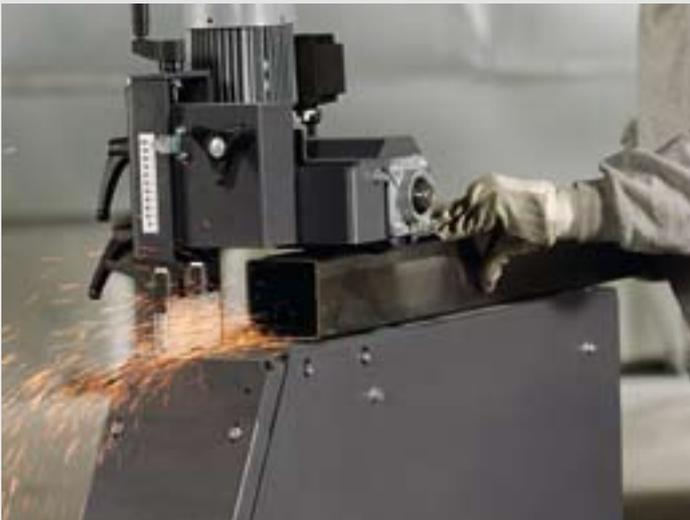
Le ponçage longitudinal de tubes carrés et de matériaux plats ou de profilés est ultra simple avec le module de ponçage longitudinal GRIT GIL unique en son genre, tout comme la transformation de la machine en ponceuse de surface. Les dimensions de bande de la machine servant de base demeurent inchangées. Cette solution GRIT a fait l'objet d'un brevet.
