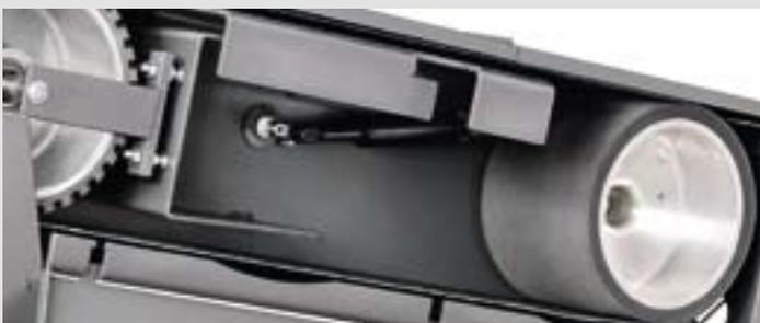
La tension de la bande par vérin à gaz compense automatiquement les tolérances dimensionnelles des bandes. En combinaison avec une roue d'entraînement à revêtement polyuréthane, vous obtenez une tension de bande optimale, sans glissement.
