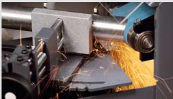
Module spécifique pour le grugeage de diverses pièces telles que tubes, tubes carrés, matériaux plats et profilés.
