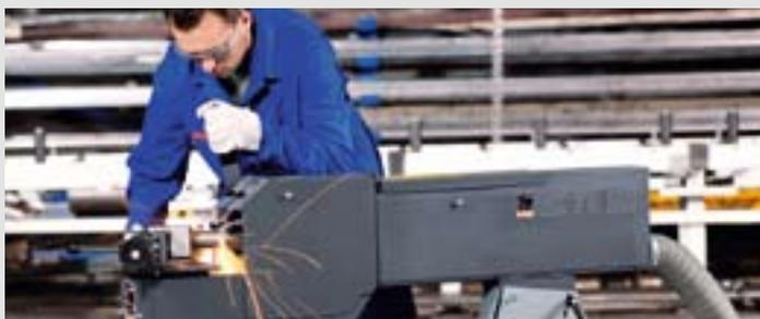
Qu'il s'agisse du ponçage de tubes, de profilés ou de barres pleines – le module de grugeage GRIT GXR est l'outil idéal, équipé en standard: d'un chariot réglable rapidement avec précision par rapport à l'angle à gruger, d'un étau équipé de mors de serrage en acier inoxydable et d'un dispositif de serrage rapide unique. Cela garantit un grugeage précis en toute sécurité.
