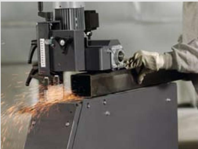
Avec la ponceuse de surface GRIT unique en son genre, le ponçage longitudinal de tubes carrés et de matériaux plats ou de profilés devient simple. Les dimensions de bande de la machine servant de base demeurent inchangées (2000 mm). Cette solution GRIT est brevetée.
