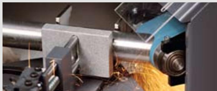
La vaste gamme de rouleaux de contact de contact GRIT couvre tous les diamètres de tubes courants. C'est ainsi qu'il est possible de gruger avec précision les tubes avec un diamètre de 16 à 70 mm et un angle d'inclinaison de 30° à 90° à l'aide d'un module de grugeage.
