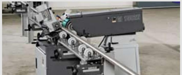
Un ponçage des diamètres les plus divers jusqu'à une longueur de 6 m est possible sans problème avec le guide-tube optionnel .
