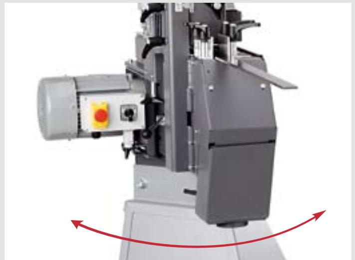
Grâce à l'embase rotative GRIT GIT (disponible en option, référence 6 99 02 176 00 0) et à la construction modulaire de la machine, vous pouvez également utiliser le module GRIT GIL de manière optimale aux endroits exigus puisque l'encombrement de travail peut facilement être adaptée à l'implantation. La plage de pivotement continue est située entre 0° et 90°.
