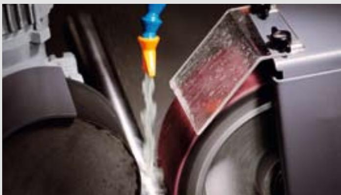
Module spécifique pour l'application de ponçage «centerless», du ponçage d'ébauche la préparation au polissage.
