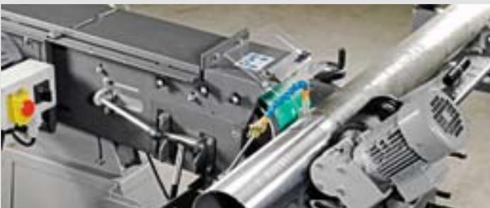
Excellents résultats lors du ponçage avec arrosage. Le refroidissement efficace avec le module de lubrification permet de réduire considérablement la température de la pièce à travailler, ce qui est particulièrement avantageux pour le ponçage de l'acier inoxydable. Une surchauffe est exclue et le risque de corrosion réduit. En combinaison avec le dispositif de nettoyage, en option, la pièce à travailler est automatiquement libérée de la poussière de ponçage et de l'eau excédentaire.
