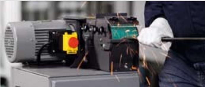
Idéale pour le ponçage, le chanfreinage et l'ébavurage de petites pièces. En combinaison avec le pied de machine GRIT GIXBE, les poussières de ponçage sont aspirées par un filtre pour poussières fines.
