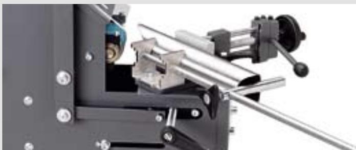
La butée longitudinale réglable du module de grugeage GRIT GXR garantit une précision constante des résultats lors du grugeage en série. Elle est facilement montable a posteriori et réglable sur une longueur de 1000 mm.
