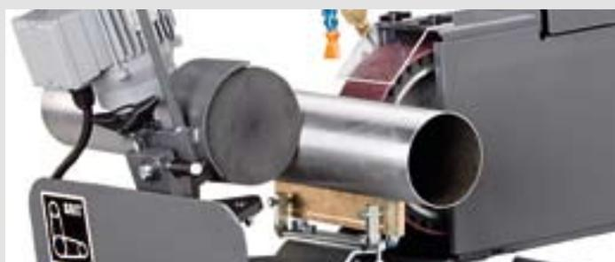
Les différents rails de guidage contenus dans la livraison sont adaptés à la nature de la surface de la pièce à travailler. Le rail de guidage en laiton est conçu pour les surfaces rugueuses comme par exemple les surfaces corrosives ou l'amadou, ou encore pour le ponçage à sec. Le rail de guidage en nylon est idéal pour la finition de surface et pour les matériaux délicats.
