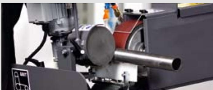
Pour le module de ponçage des tubes, une surface parfaite et une grande vitesse de ponçage de tubes et d'arbres ne sont pas contradictoires. La vitesse d'avance peut être réglée en continu en fonction du matériau à poncer, jusqu'à 2 mètres par minute au maximum.
