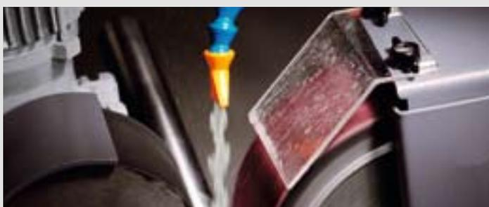
Le ponçage avec arrosage avec le module de lubrification GRIT GXW garantit des résultats supérieurs : la poussière de ponçage est immédiatement liée et la durée de vie des bandes abrasives est prolongée grâce au refroidissement. Qui plus est, le risque de corrosion des tubes en acier inoxydable est réduit grâce au faible dégagement de chaleur lors du ponçage. Un circuit fermé assure une utilisation économique du lubrifiant.
