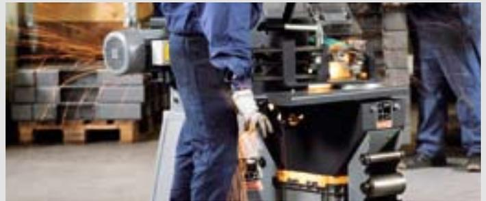
La solution parfaite pour un grugeage de précision de tubes, de tubes carrés, de matériaux plats et de profilés dans l'industrie.
