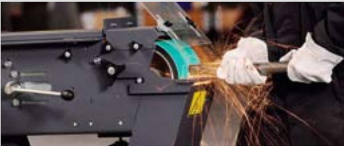
Ponceuses à bande haute performance pour une utilisation Heavy-Duty. La base de la gamme modulaire GRIT GI, disponible en modèle à une ou deux vitesses de rotation. Peut aussi être utilisée comme ponceuse à bande seule.
