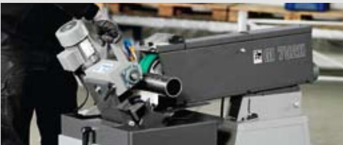
Ponçage automatique de tubes à haute rentabilité – du dégrossissage à la finition. Livre des résultats parfaits en combinaison avec le module de lubrification GRIT GXW à faible température.
