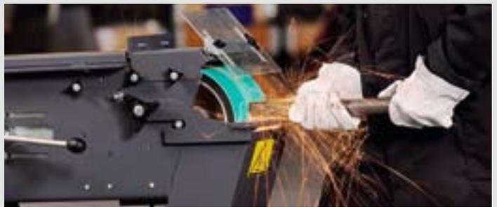
La solution idéale pour les applications de ponçage à bande standard. Le puissant moteur S1, combiné à la roue de contact GRIT à rainure spéciale et aux bandes abrasives haute performance GRIT, garantit une vitesse de travail exceptionnelle et d'excellents résultats également en cas d'utilisation continue.
