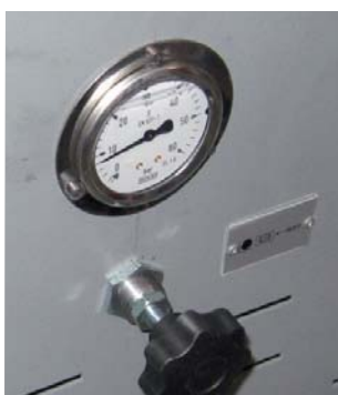
RPM1 Regolazione pressione morsa Vice pressure adjustment Reglage de la pression de serrage de l'etau
