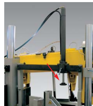
TP Gruppo premittore taglio a pacco Cylinder for vertical clamping Serrage vertical pour paquets
