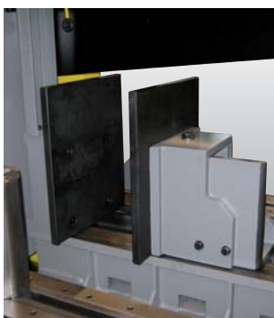
GTP Ganasce taglio a pacco Jaws for pack cutting Machoirs pour la coupe à paquet
