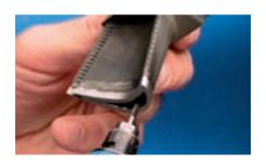
Fraise sur tige cylindrique selon DIN 8032 avec denture en périphérie et en bout selon DIN 8033.
