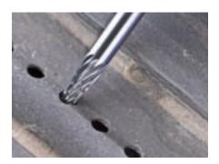
Fraise sur tige conique à bout pointu selon DIN 8032 avec denture selon DIN 8033, pointe aplatie.
