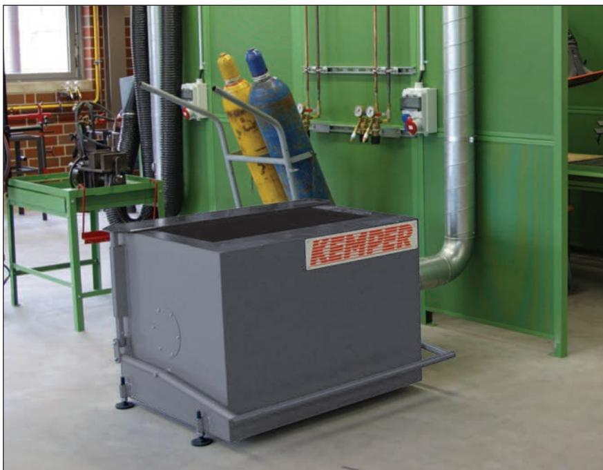
Table surtout conçue pour la mise en oeuvre dans des centres de formation pour le coupage plasma manuel. Le système de serrage des tôles d'une épaisseur de 10 mm, peut être facilement commandé par un système à pédale. Afin d'éviter que les poussières générées se répandent dans l'atelier, la table doit être raccordée à un système d'aspiration centralisé ou à un ventilateur. Un grand tiroir de récupération des poussières facilite le nettoyage de la table.
