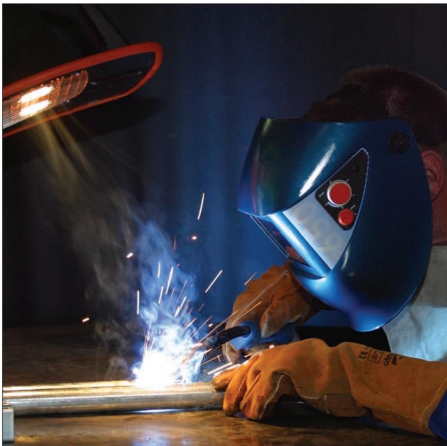
Les rayonnements divers se produisant lors de la soudure sont particulièrement nuisibles à l'œil humain. Ainsi, il n'est pas seulement nécessaire de protéger le soudeur à son poste de travail par les mesures convenables, il faut également protéger ses collègues qui ont un contact direct avec la soudure.
