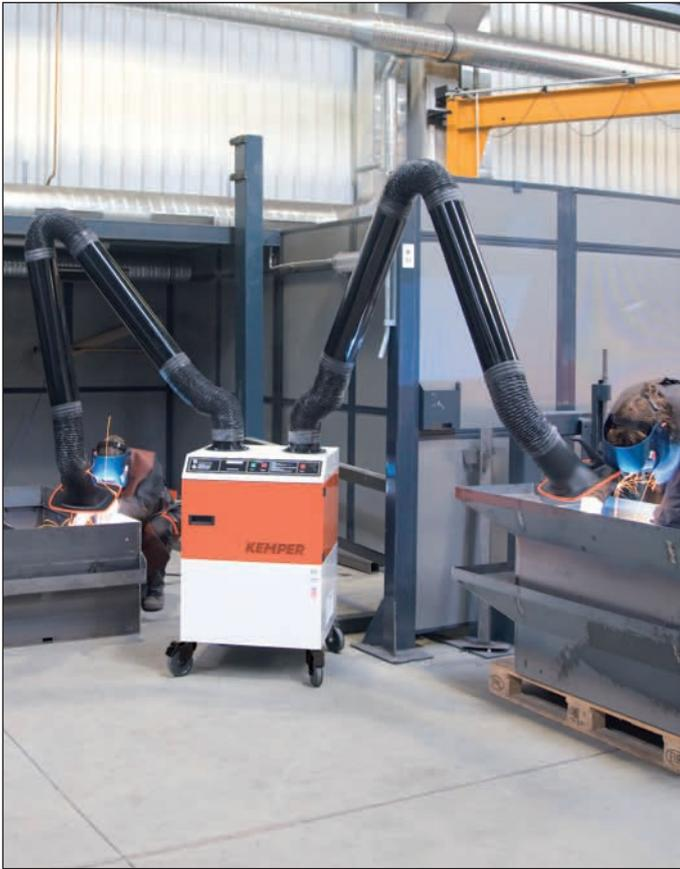
Filtre de fumées de soudure mécanique mobile pour l'aspiration simultanée sur 2 postes de soudage. Livrable avec 2 bras en version gaine souple ou rigide, pivotant tous les deux à 360°.
