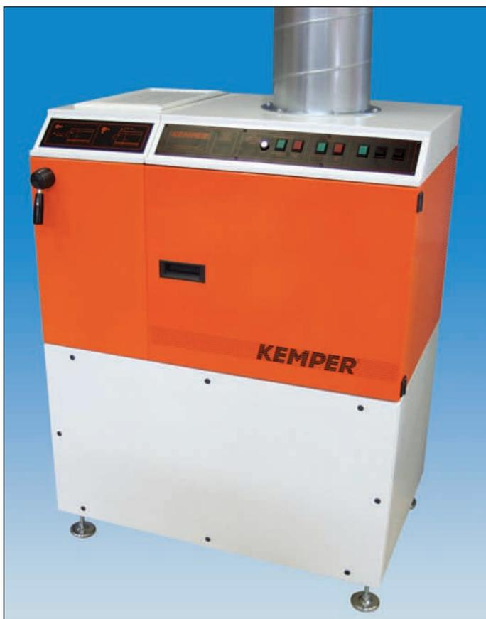
Le système d'aspiration *KEMPER* pour fumées de brasage est conçu pour l'aspiration jusqu'à 15 postes de travail ou pour le raccordement sur une machine de brasage automatique. Il est équipé d'un filtre combiné particules/gaz et s'adapte aux besoins d'aspiration grâce au clapet de réglage se trouvant dans la tuyauterie.
