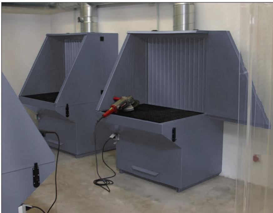
Livrables en plusieurs tailles, ces tables peuvent être raccordées à une installation centralisée d'aspiration et de filtration.
