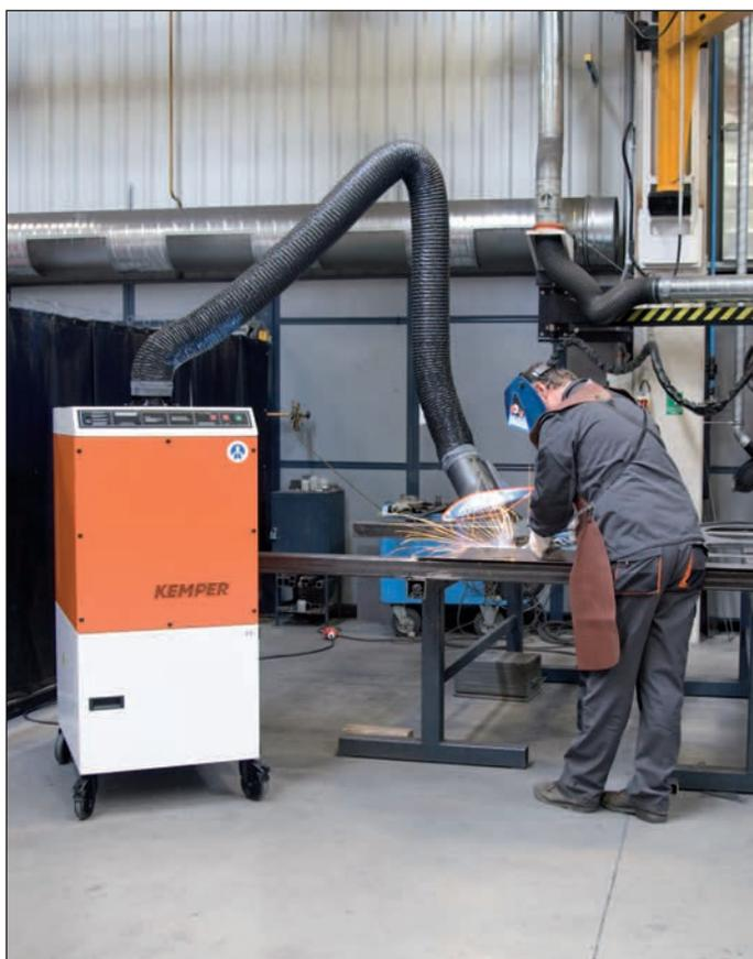
Appareil d'aspiration de fumées de soudure mobile avec deux cartouches KemTex® à membrane téflonnée pour la mise en oeuvre dans le milieu industriel. Les cartouches fonctionnent selon le principe de la filtration en surface: les polluants sont arrêtés à la surface du média filtrant grâce à une membrane téflonnée laminée. De ce fait, le décolmatage des cartouches peut se faire par air comprimé. Le degré de séparation des particules inférieures à 0,4 µm garantit une grande sécurité.
