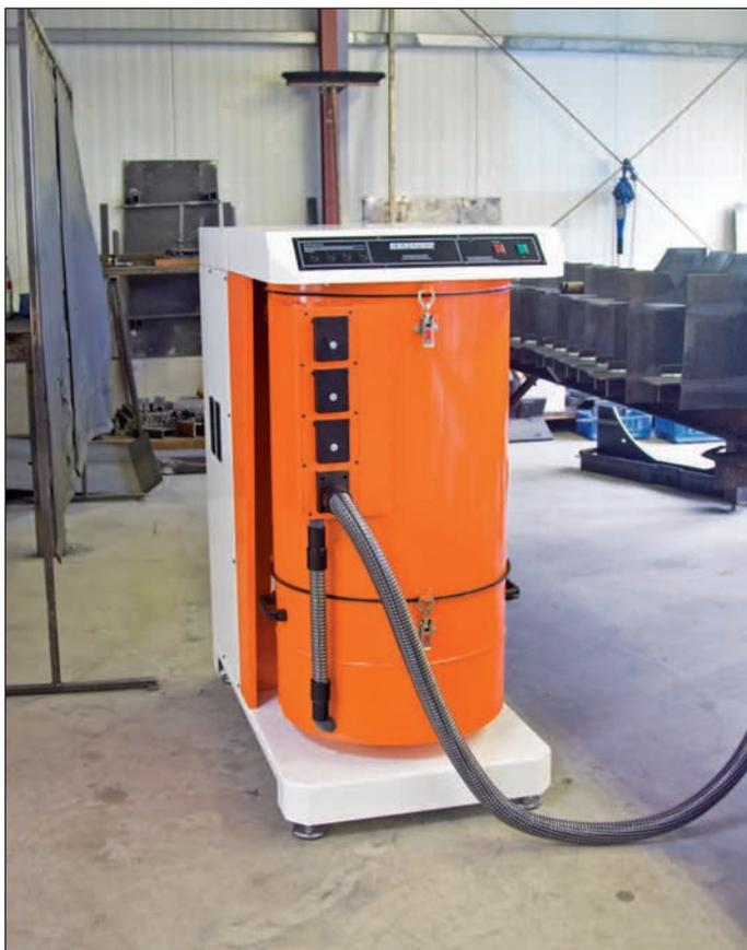
De par ses quatre branchements, cette unité d'aspiration représente une solution flexible pour la captation directement à la source de l'air pollué. Le système est équipé d'un compresseur à canal latéral, efficace également dans des conditions de mise en oeuvre extrêmes.
