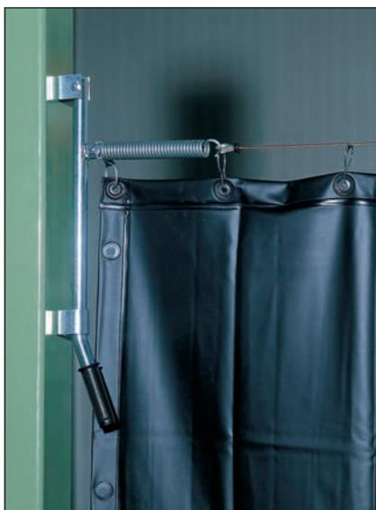
Conçu pour rideaux de largeur maxi. 8,0 m. Le rideau est accroché à un câble tendu. En repoussant le rideau et en décrochant le câble, celui-ci s'enroule automatiquement et l'enrouleur pivotant peut être rabattu sur le côté.
