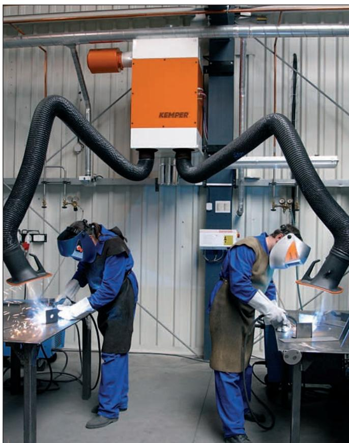
Economisant la surface au sol, ces appareils, fixés aux murs ou sur des piliers-support, sont particulièrement adaptés pour desservir des postes de soudage stationnaires, des cabines de soudure et des centres de formation.
