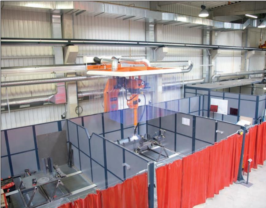
Pour l'aspiration sur des postes de soudure robotisés en production industrielle, il existe diverses possibilités avec les systèmes 8000 et 9000.
