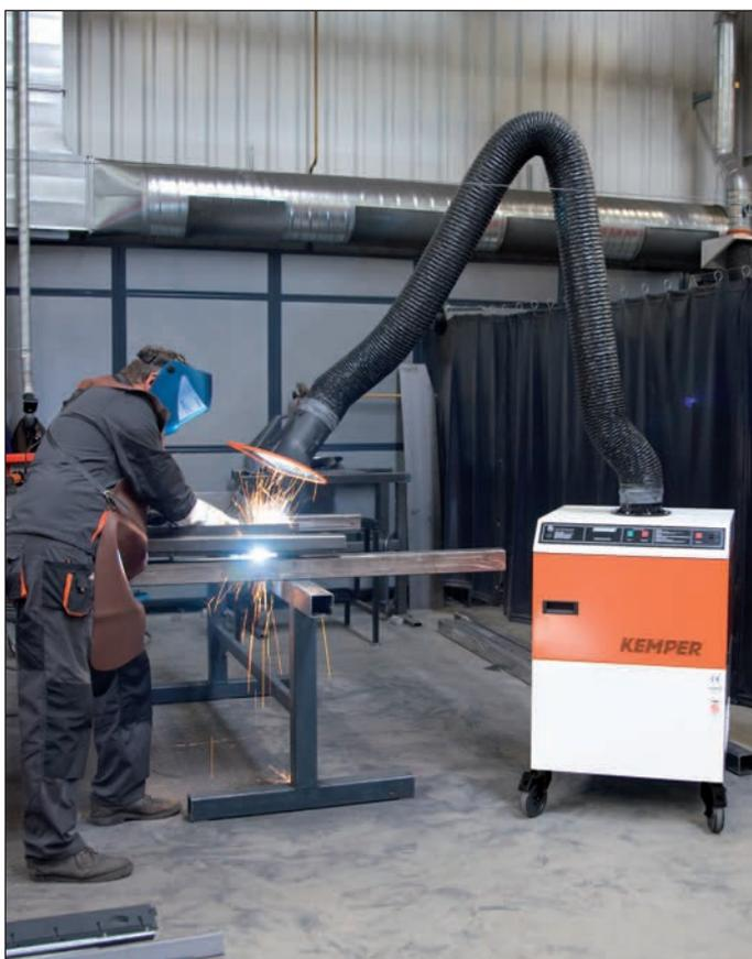
Appareil convenant spécialement pour la mise en oeuvre sur les postes mobiles. Le système de filtration est différent, fonctionnant selon le principe du chargement électrique positif et négatif.
