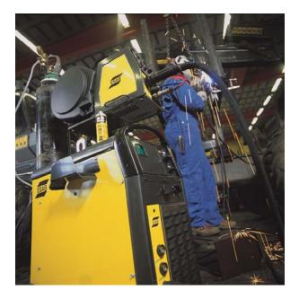
Les séries avec ampère/voltmètre calibré et intégré fournissent une lecture précise des paramètres de soudage. Les valeurs restent affichées même après la fin de l'opération de soudage.
